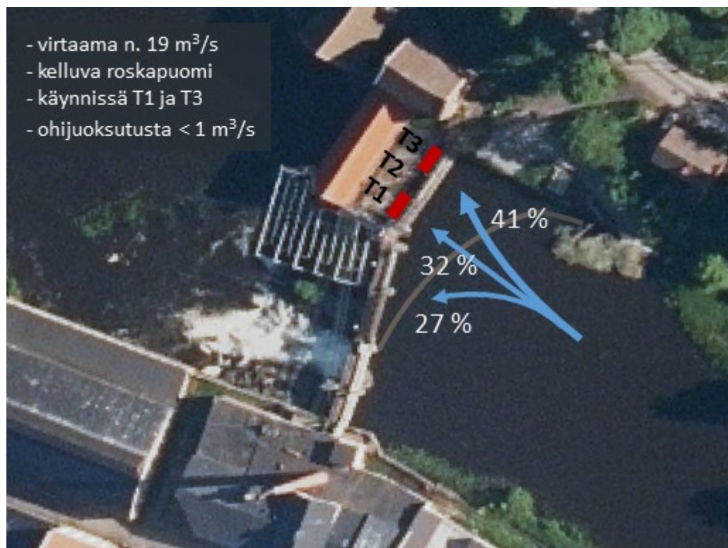
Kuva 9. Erän 1 kalojen saapumissuunnat ja jakautuminen Billnäsin voimalaitospadolla. Käynnissä olleet turbiinit on merkitty punaisella. (Maanmittauslaitos)
