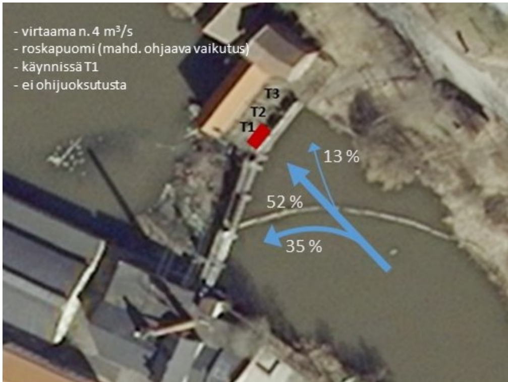
Kuva 12. Vuoden 2017 lähetinkalojen saapumissuunnat ja jakautuminen Billnäsin voimalaitospadolla. Käynnissä ollut turbiini on merkitty punaisella. (Maanmittauslaitos)
