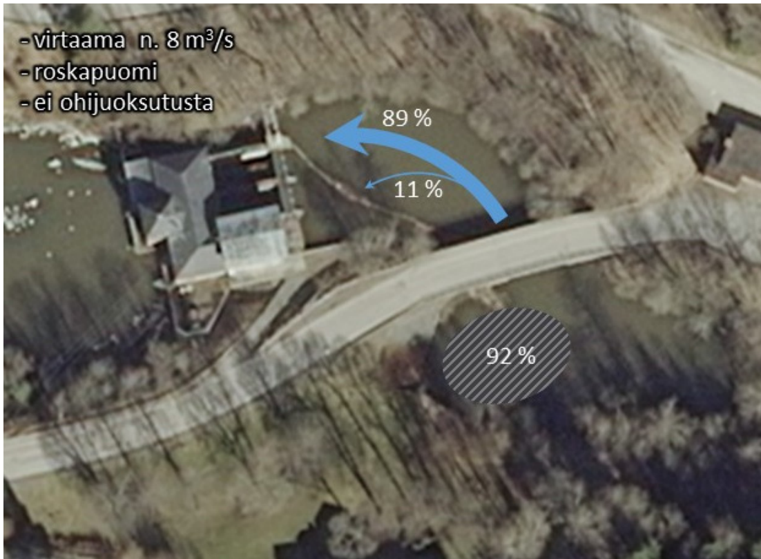
Kuva 17. Kalojen saapumissuunnat ja jakautuminen Åminneforsin voimalaitospadolla vuonna 2017. Kalat saapuivat voimalaitokselle pääasiassa uoman oikeassa reunassa. Sieltä ne siirtyivät myöhemmin voimalaitoksen turbiinkanavan edustalle (harmaa katkonainen nuoli). Turbiinkanavan välppä on merkitty punaisella. Lisäksi karttaan on merkitty alue (viivoitettu), jossa lähes kaikki kalat pysähtyivät ennen siirtymistä voimalaitokselle. (Maanmittauslaitos)
