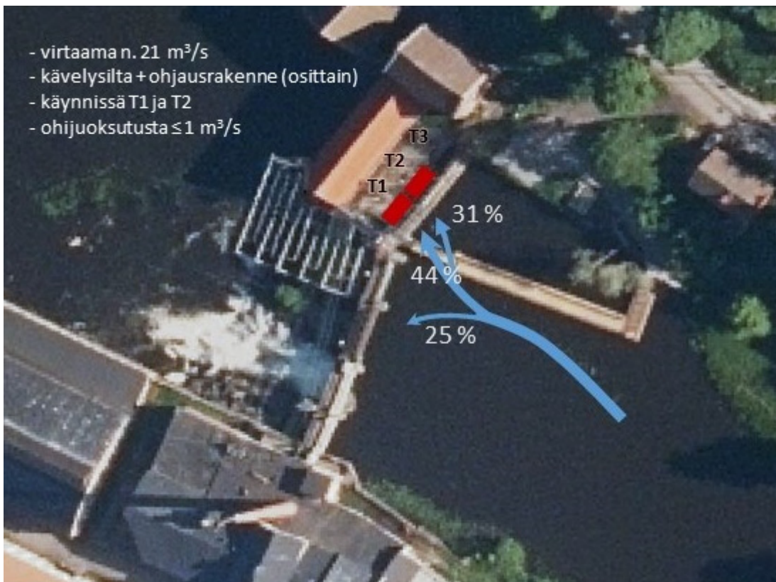
Kuva 11. Erän 3 kalojen saapumissuunnat ja jakautuminen Billnäsin voimalaitospadolla. Käynnissä olleet turbiinit on merkitty punaisella. (Maanmittauslaitos)
